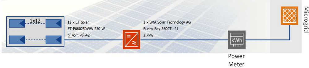
Fig. 5-1 Schema bloc sistem fotovoltaic – PV*Sol
